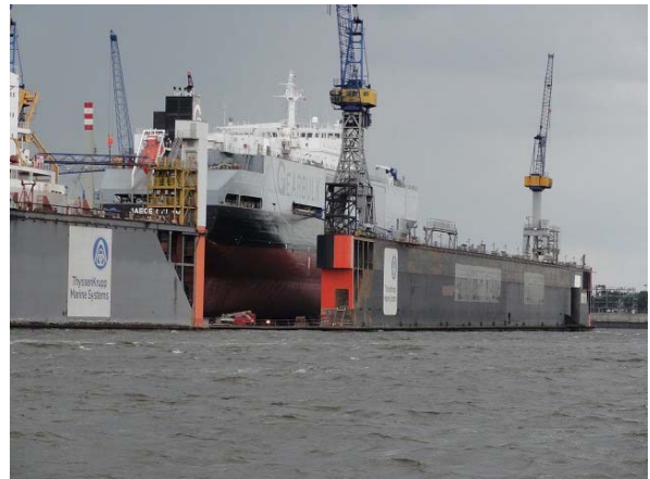
フローティングドックで修理中の船舶
